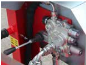
Commande hydraulique du chevalet
