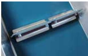
Bandes interchangeables avec barrettes métalliques
