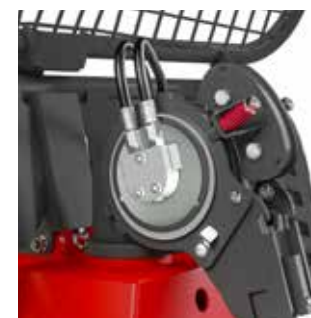
Poulie hydraulique avec meilleur accompagnement du câble (breveté)
