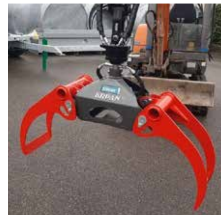
Grappin 1,20 m avec adaptation sur mini-pelle
