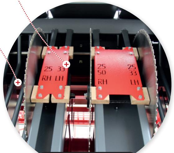
**Capot arrière arrière ouvert : réglage des lames**
