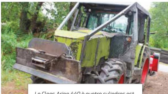
Le Claas Arion 440 à quatre cylindres est équipé d'un blindage complet.
