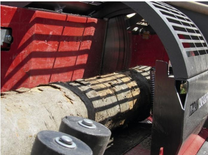
**La scie circulaire d'un mètre de diamètre améliore la rapidité d'exécution et les rendements obtenus.** *D.Seytre/Le Bois International*
