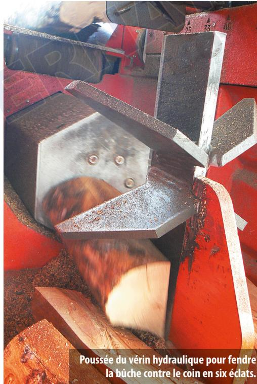
**Poussée du vérin hydraulique pour fendre la bûche contre le coin en six éclats.**
