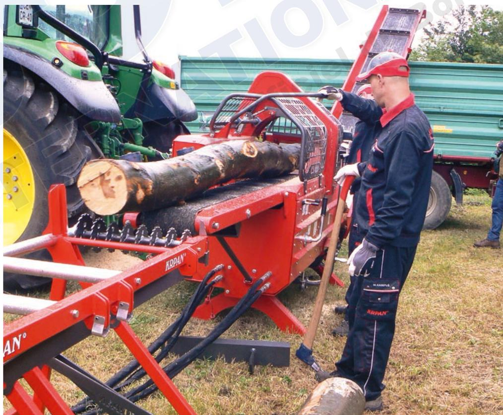
Le nouveau combiné CS 420 permet de fendre des billons de 42 cm de diamètre.
