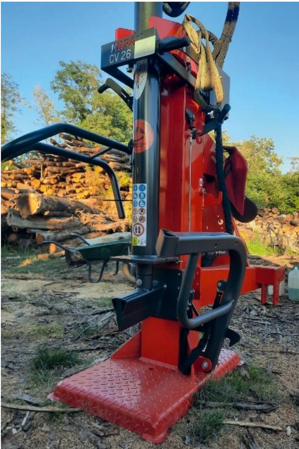
Vue sur la fendeuse avec le vérin replié en position de transport et le bras de relevage sur la droite. *Photo : F. Cornille*
