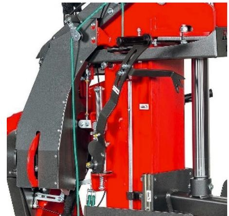
Bras de maintien avec griffe situé sur le côté gauche de la fendeuse.
