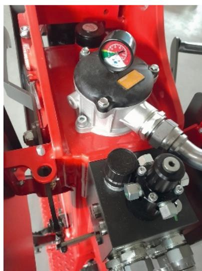
Distributeur avec deux vitesses automatiques et filtre retour avec témoin de colmatage.
