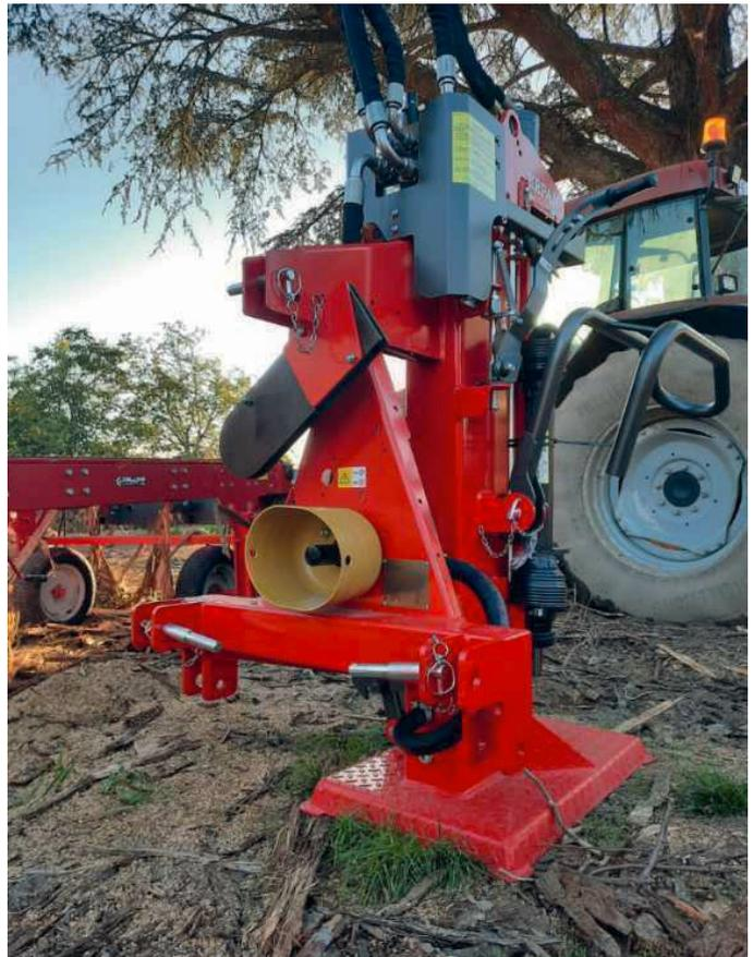
Vue sur l'arrière de la fendeuse CV 26Kpro avec présence du support pour la tronçonneuse. *Photo : F. Cornille*
