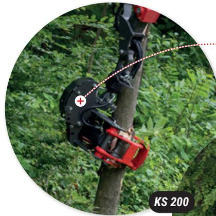
Fonction TILT : Le grappin se met en position horizontale à l'ouverture puis verticale à la fermeture (sauf version B)
