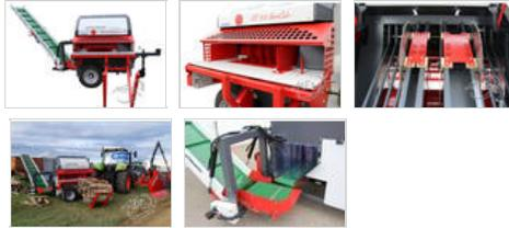
Conçue pour longueurs de 1m pouvant être divisées jusqu'à quatre parties en un cycle.
