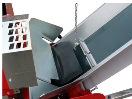
Entonnoir fixe renforcé sur version 5m
