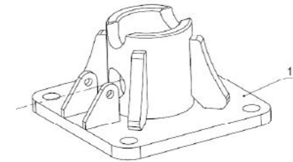
Plaque 140x140 grappin Pro vers rotator avec douille
