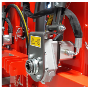
Pompe à flasquer et bride de blocage sur 17Meco
