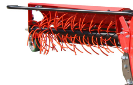
Palpeur avec position de déclenchement réglable
