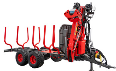
Encombrement réduit avec grue en Z + report de charge à l'avant
