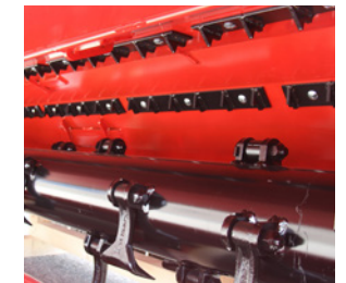
Rotor avec marteaux long et 3 rangées de contre couteaux
