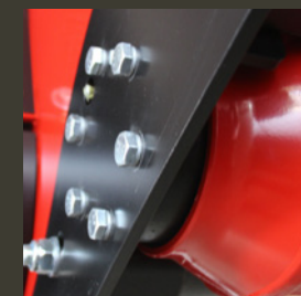
Palier du rouleau palpeur triple lamelle + joint 100% étanche
