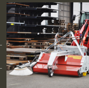
Option balai latéral sur modèles attelage avant et arrière suivant conditions
