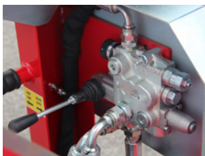
Commande hydraulique du chevalet / Automatique en option
