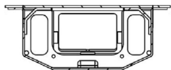
Chassis monocoque vue en coupe
