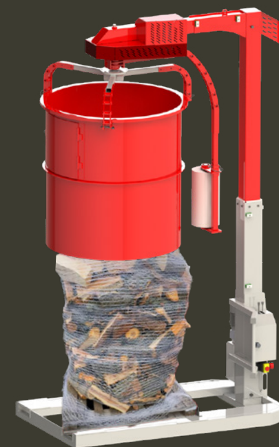
Ensachage par un filet ou film étirable
