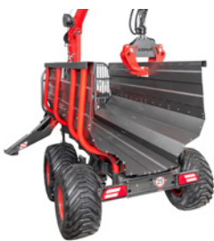
Option caisson / box pour le bois énergie
