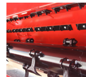
Rotor avec marteaux long et 3 rangées de contre couteaux
