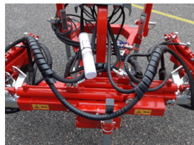
Modèle droite + gauche = vérins pour adaptation à la largeur du rang
