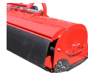
Capot avec ouverture par vérin double effet
