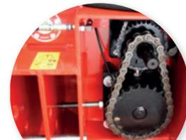
Graissage simplifié des chaînes de transmission
