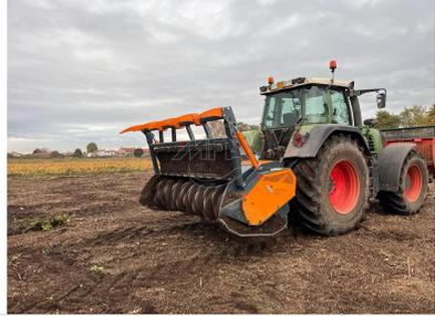
Gamme de broyeur forestier robuste permettant un broyage du bois et des souches jusqu'à 35 cm. Rotor à marteaux fixes munis de plaquettes de tungstène, les broyeurs forestiers Fischer Factory peuvent faire face aux conditions les plus difficiles, que ce soit dans l'entretien des forêts, des terres agricoles ou dans le renouvellement de vergers.
